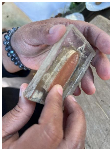
ภาพ 25 ดันแม่พิมพ์ออกมาจากรезิ่น (ผู้นิพนธ์สร้างสรรค์เอง)
