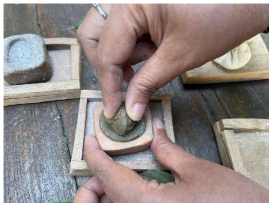
ภาพ 11 เอาดินจับแม่พิมพ์แล้วดึงขึ้นมา (ผู้นิพนธ์สร้างสรรค์เอง)
